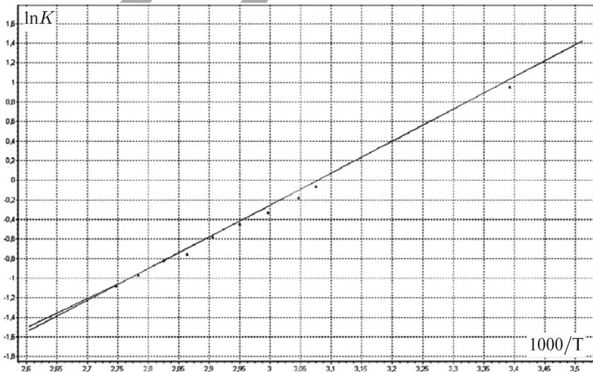
Рис. 5.20. Зависимость \ln K - 1000/T для неопентана на ГТС (линии — расчет, точки — эксперимент). Нижняя ветвь соответствует жесткой молекуле, а верхняя получена для барьера вращения 12 кДж/моль
