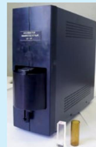
Полевой люминесцентный прибор для экспрессного определения урана (VI) в объектах окружающей среды
