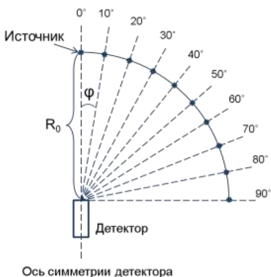
Рис. 1. Схема эксперимента по градуировке детектора.
