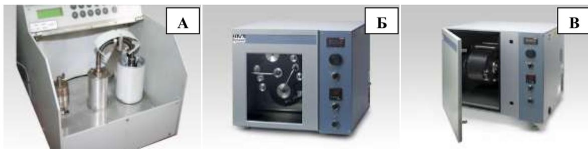
Рис. 1. Вращающиеся спиральные колонки: **А** – аналитическая ВСК объемом 15 мл; **Б** – полупрепаративная ВСК объемом 73 мл; **В** – препаративная ВСК объемом 453 мл.
