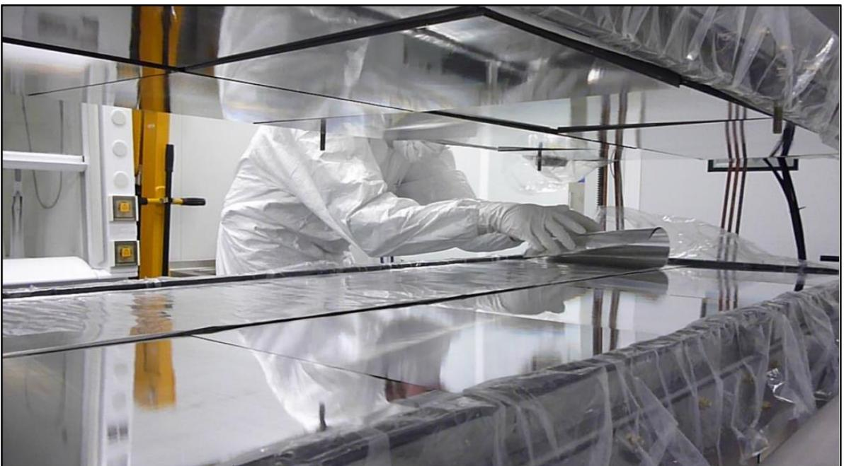
**Рисунок 10.** Процесс установки фольги в модуль ViPo-3 спектрометра.
