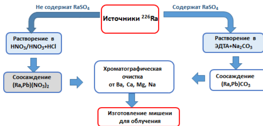
Рисунок 4. Схема переработки выдержанных радиевых источников.
