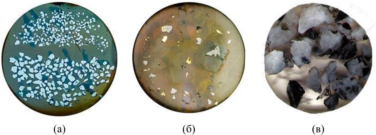
**Рисунок 44.** Полированные шайбы для проведения РСМА
