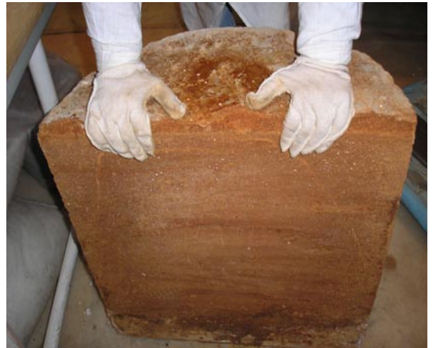
Рисунок 1.5 Внешний вид МКФ компаундов с имитаторами РАО ФГУП «ПО «Маяк», объем компаунда - 20 л (слева) и 200 л (справа) [96]
