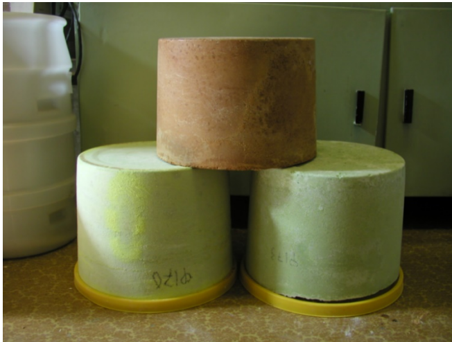
Рисунок 1.5 Внешний вид МКФ компаундов с имитаторами РАО ФГУП «ПО «Маяк», объем компаунда - 20 л (слева) и 200 л (справа) [96]
