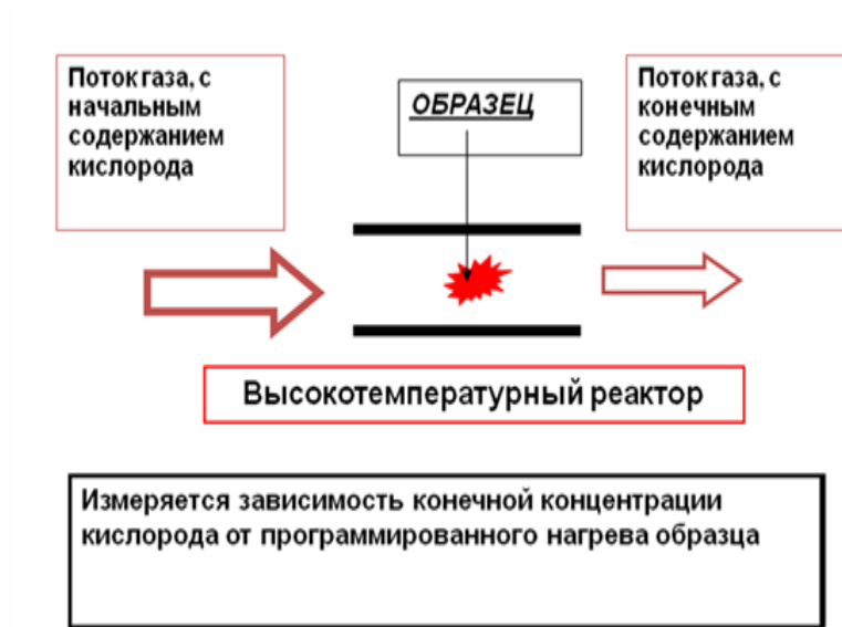
Рисунок 3. Принцип работы прибора по определению ХПК
