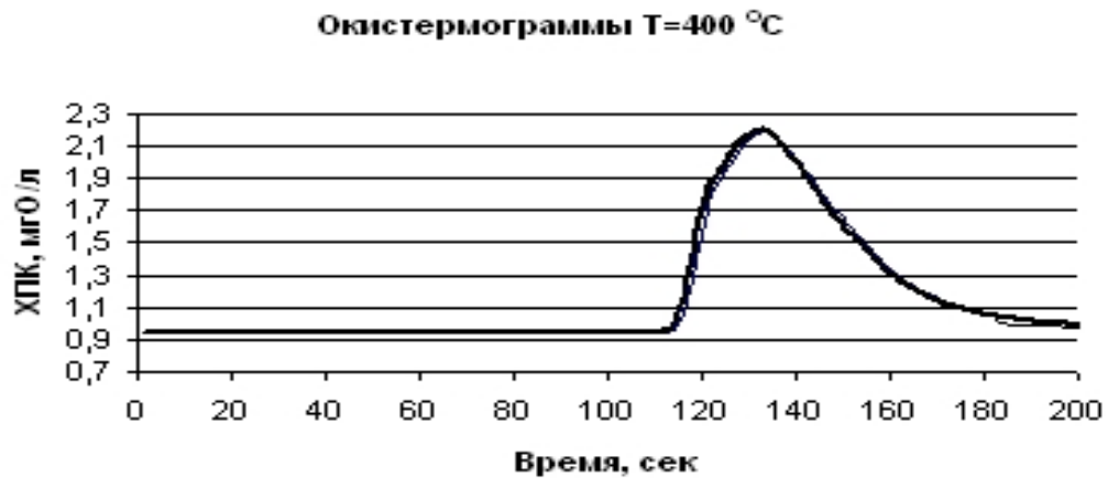
Рисунок 10. Окситермограмма, полученная при вводе цеолита в температурную зону ( T=400^{\circ}\text{C} )
