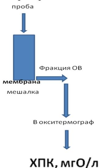
Рисунок 8. Схема мембранно-окситермографического метода
