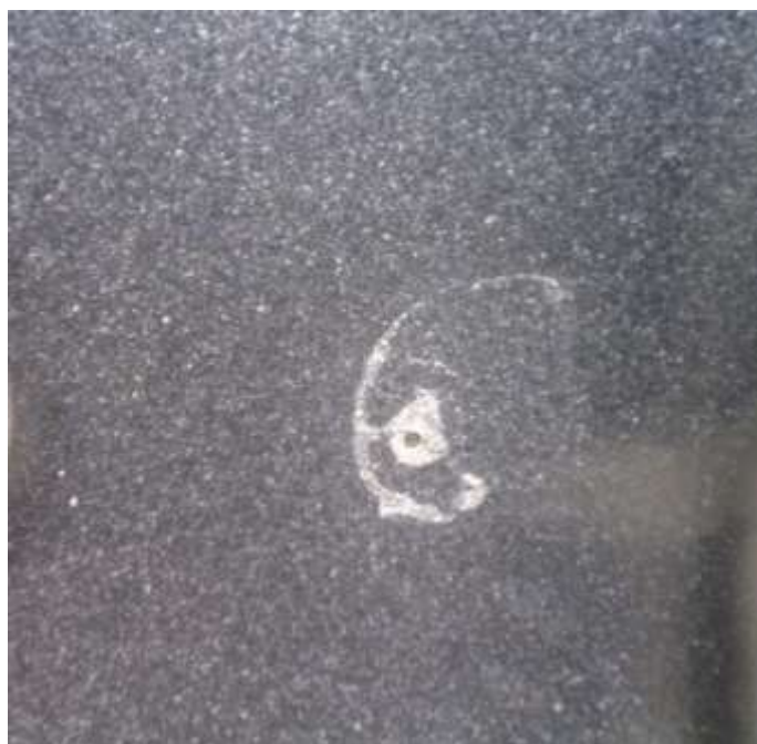
Рис. 31. Зерно сорбента после высыхания одной микрокапли раствора на основе водопроводной воды.
