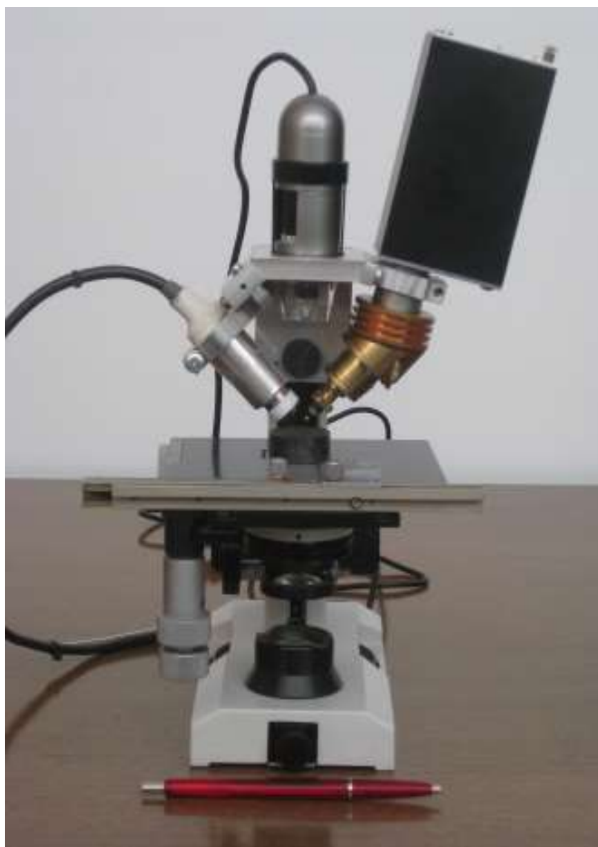
Рис. 6. Фото макетного образца спектрометра с фокусным пятном 10 мкм.
