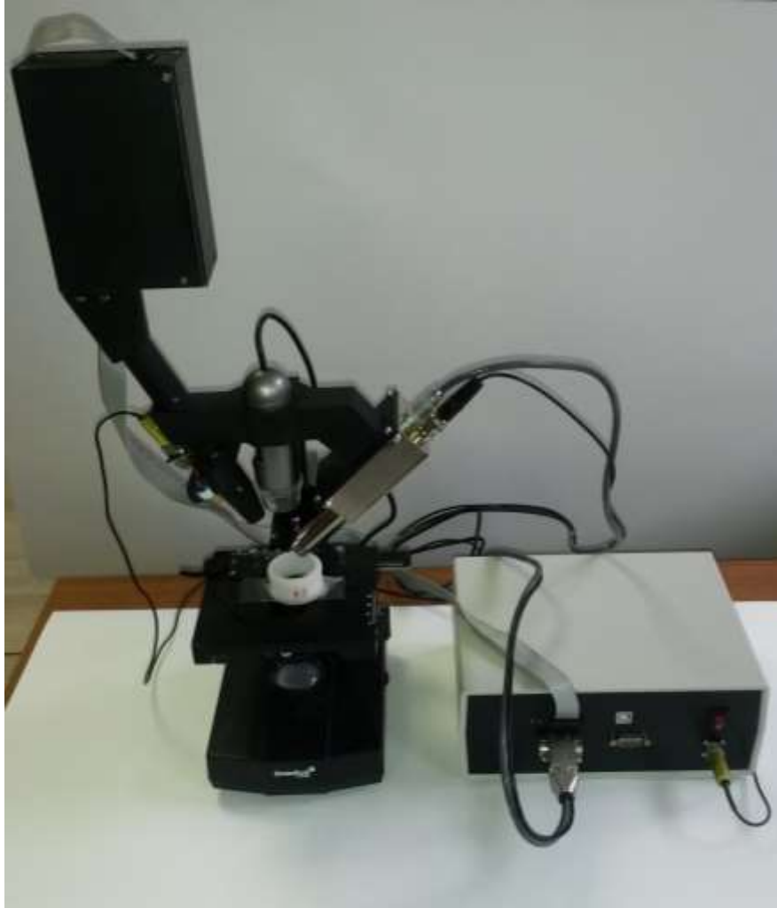
Рис. 7. Фото опытного образца спектрометра с блоком питания.
