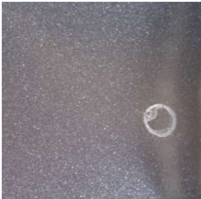
Рис. 32. Зерно сорбента после высыхания одной микрокапли раствора на основе водопроводной воды.
