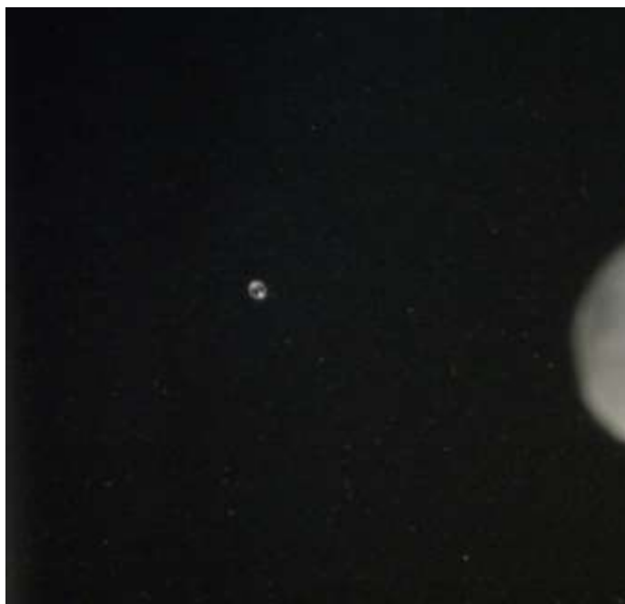
Рис. 30. Зерно сорбента после высыхания одной микрокапли раствора на основе деионизованной воды.
