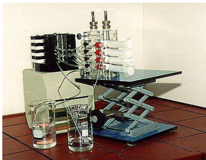
Рис. 4. Установка для последовательной ультрафильтрации.
