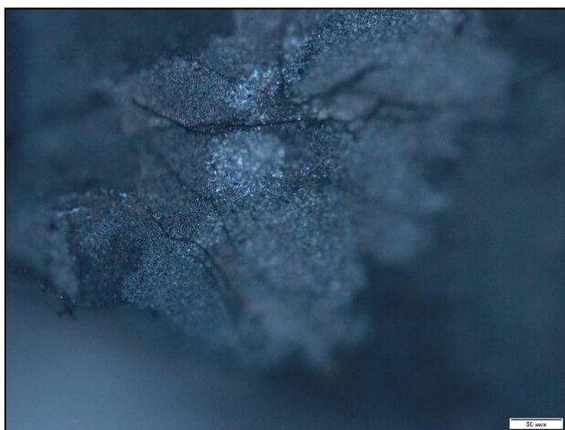
Рисунок 38 – Фотографии поверхности UPd_3 , сделанные с помощью: а – оптического микроскопа, б – сканирующего электронного микроскопа
