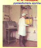
«Горячие» камеры, оснащенные образцами (до 100 Ки)
